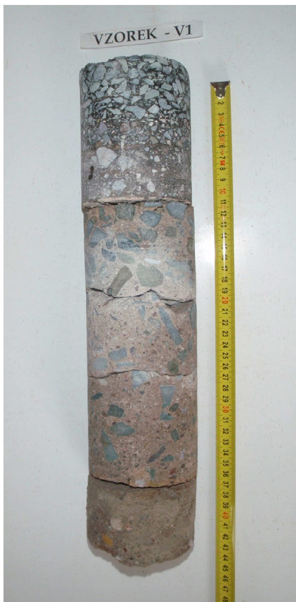
Obr. 2 - Jádro vývrtu Vzorek – V1 (laboratoř).
