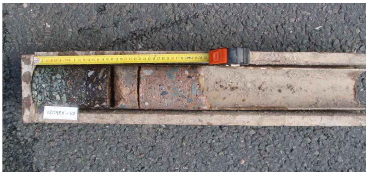
Obr. 3 - Jádro vývrtu Vzorek – V2 (in situ).
