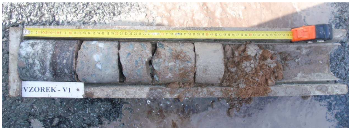
Obr. 1 - Jádro vývrtu Vzorek – V1 (in situ).
